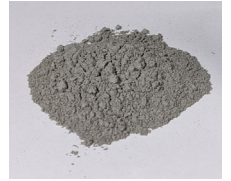
粉砕したコンクリートがれき
